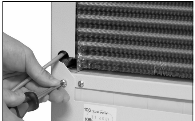
Bild 28: Ta bort huvens fastsättningskruvar (lossa de fyra skruvarna)
