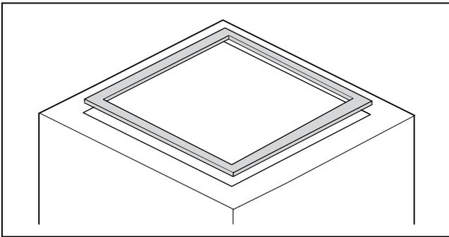
イラスト 8: トップパネルヘシーリングフレームを貼り付ける
