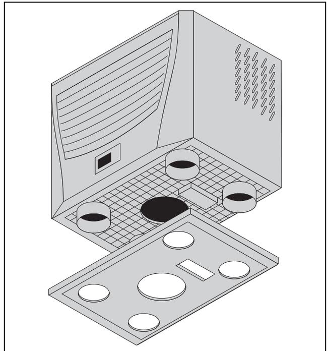
イラスト 10: シーリングプレートをクーリングユニットのプラスチック製ベースの下へ貼り付ける
