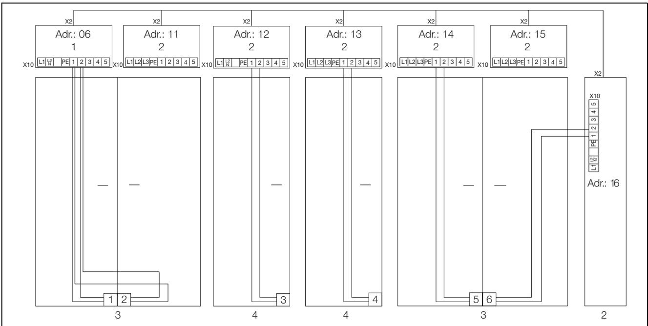
イラスト 15： 接続例：ドアスイッチおよびマスター スレーブ運転
