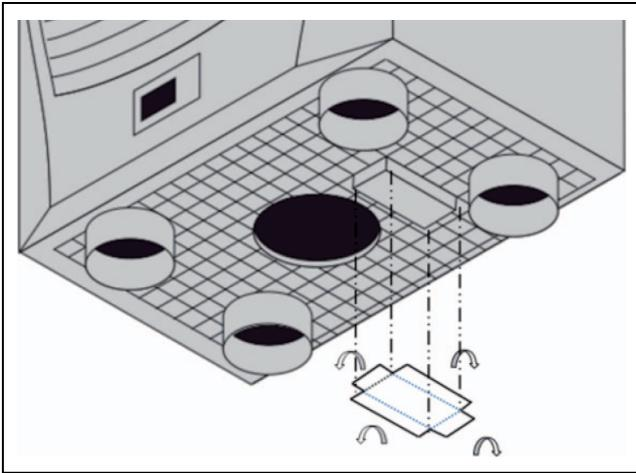
イラスト 9: クーリングユニットの凝縮水蒸発器のハウジング周囲に絶縁フィルムを
