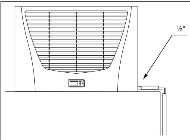
イラスト 12: 凝縮水排水管を敷設する
