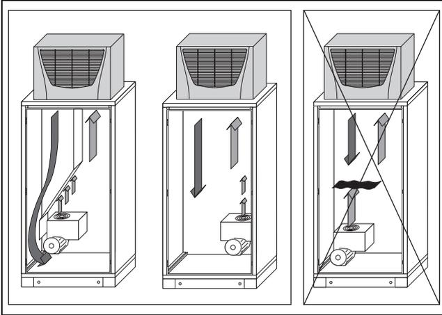
イラスト 5: 冷風を稼働中の機器に向けない
