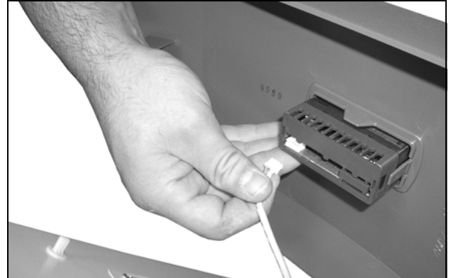
Rys. 60: Odłączanie kabla wyświetlacza
