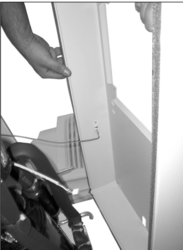
Rys. 72: Odłączanie kabla uziemiającego (1)
