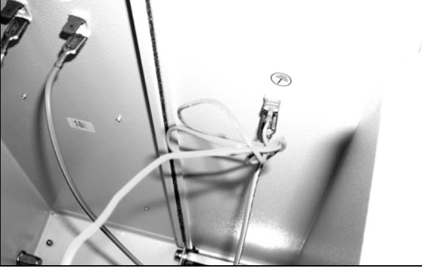
Şek. 68: Fanın topraklama kablosunu çıkarın (1)
