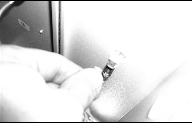
Şek. 69: Fanın topraklama kablosunu çıkarın (2)
