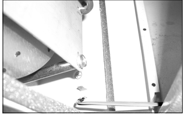
Şek. 49: Başlık ile şasi arasındaki topraklama kablosunu çözün (1)
