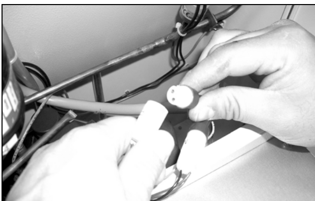
Bild 67: Dra ut fläktens kontaktodn (3)
