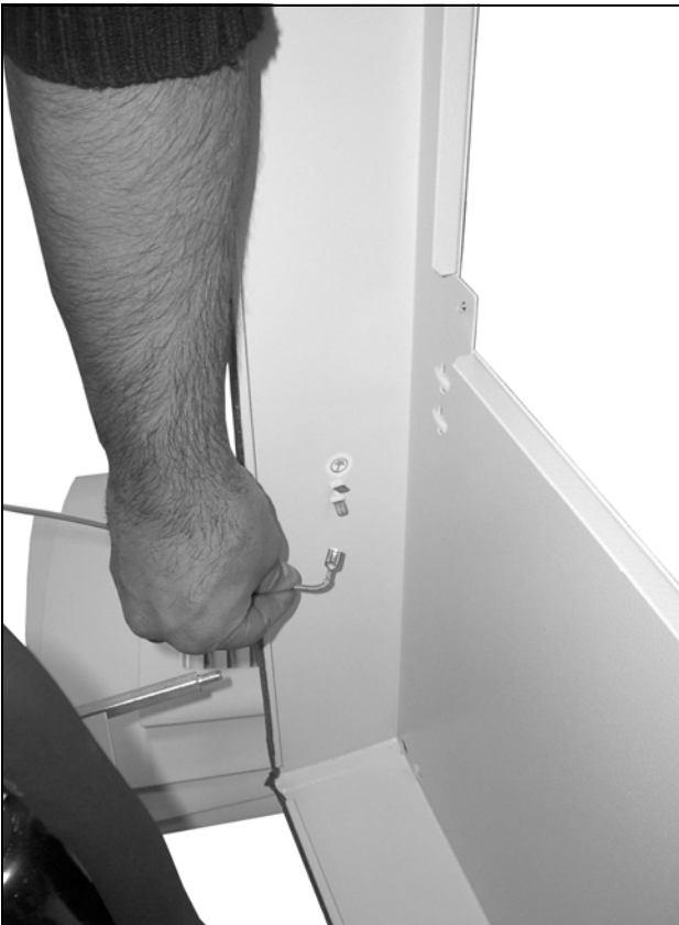
Bild 73: Dra ut jordkabeln (2)
