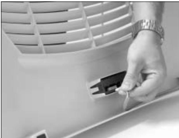
Fig. 34 : Ôter le connecteur de l'afficheur
