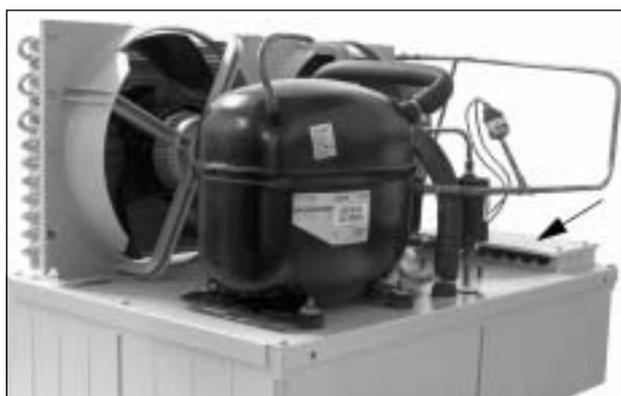
Fig. 39: Condizionatore senza cuffia di copertura (vista posteriore)
