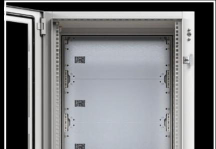
Die an der Rückseite des Wandgehäuses angeschweißte Montagelochleiste mit U-Profil und Systemlochung ermöglicht einen flexiblen Ausbau im 25 mm-Maßraster mit Chassis und Schienen.
