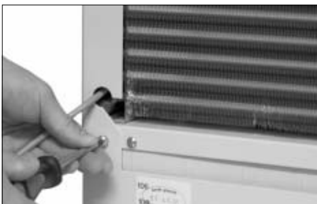
Afb. 36: Bevestigingsschroeven van de afdekkap verwijderen (vier schroeven losdraaien)
