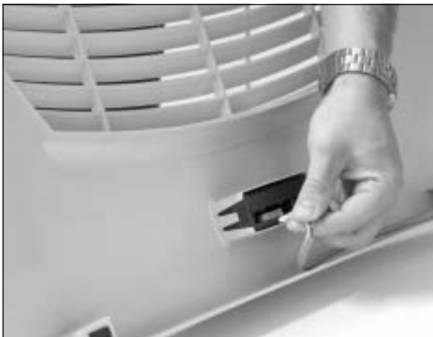
Afb. 34: Connector van het display losnemen
