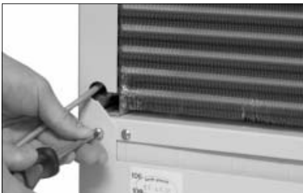
Bild 36: Ta bort huvens fastsättningsskruvar (lossa på de fyra skruvarna)
