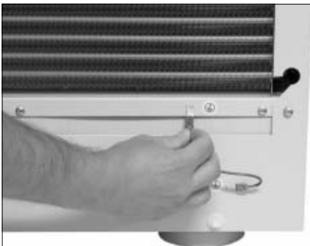
Bild 35: Dra ut jordningskabel
