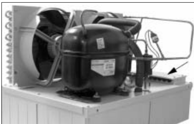
Bild 39: Kylaggregat utan huv (vy från baksidan)
