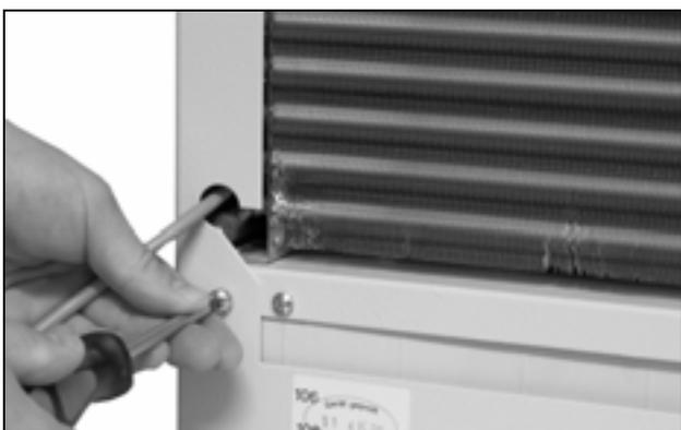
Рис. 36: Отвинчивание крепежных винтов кожуха (четыре винта)
