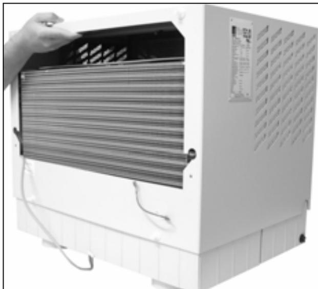
Рис. 37: Снятие кожуха
