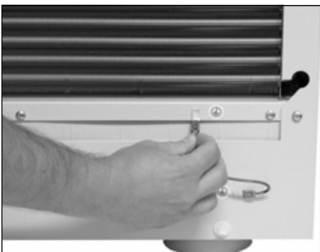
Рис. 35: Отсоединение кабеля заземления
