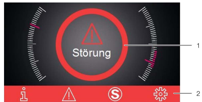
Abb. 19: Bildschirm bei Auftreten einer Störung
