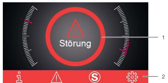
Abb. 28: Bildschirm bei Auftreten einer Störung
