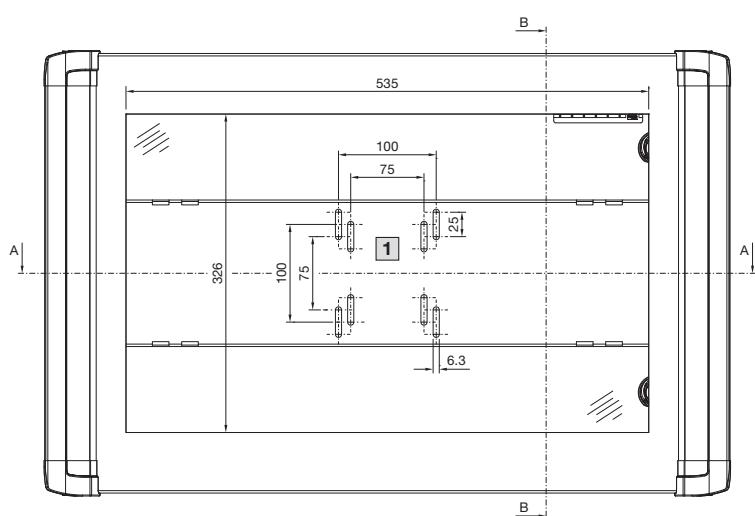
**1** Monitor in der Höhe stufenlos verstellbar
