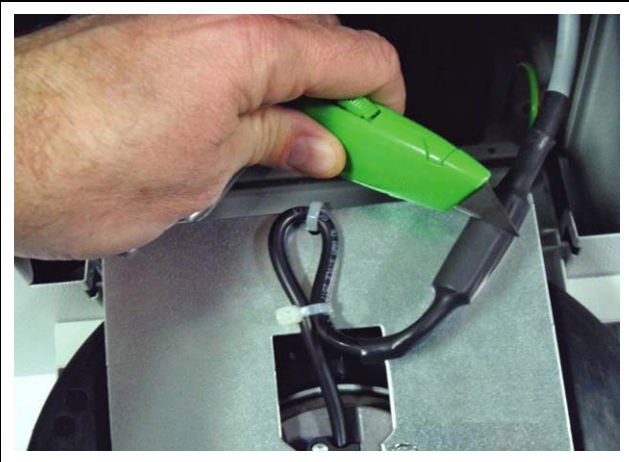
Fig. 24: Schrumpfschlauch, der den Steckverbinder ummantelt, abschneiden
