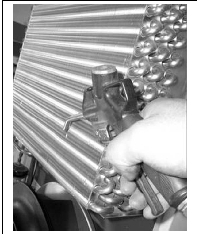
Fig. 27: Wärmetauschregister und Kompressorraum mit Druckluft ausblasen
