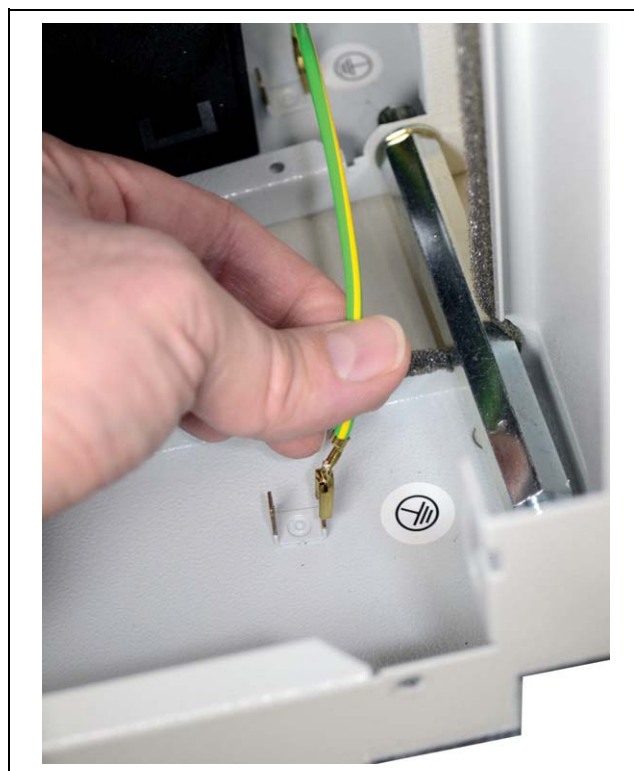
Fig. 23 : retirer le câble de mise à la terre qui se trouve entre le capot et le châssis
