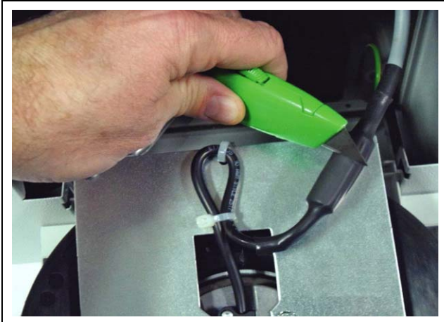
Fig. 24 : couper la gaine thermorétractable qui enveloppe le connecteur
