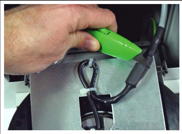
Fig. 24: Cortar la cubierta termorretráctil que recubre el conector
