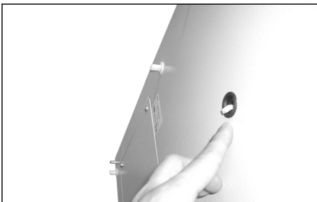
Imagen 46: Presionar el cable del display a través de la entrada de cables
