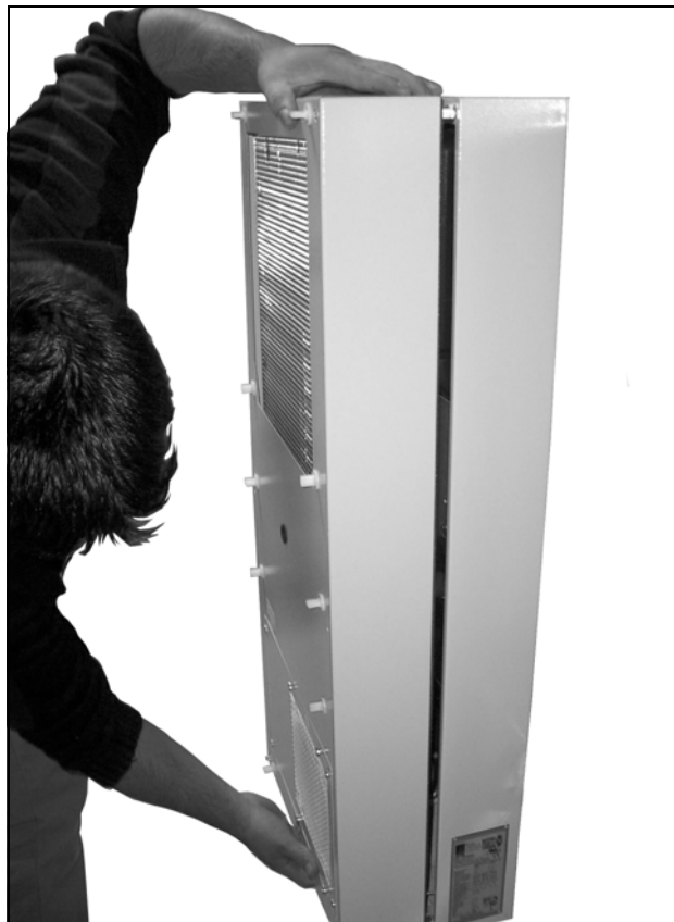
Imagen 47: Retirar la cubierta (1)
