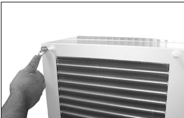
Imagen 44: Desmontar la cubierta (extraer las cuatro tuercas)
