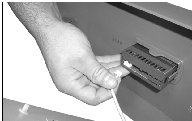
Imagen 60: Desconectar el cable del display
