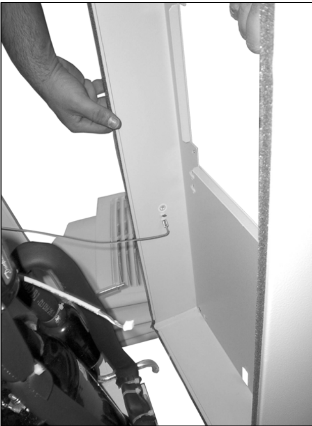
Imagen 72: Desconectar el cable de puesta a tierra (1)
