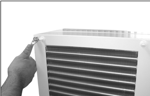
Afb. 44: Afdekplaat demonteren (vier moeren losdraaien)
