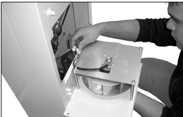
Afb. 65: Connectoren van de ventilator losnemen (1)
