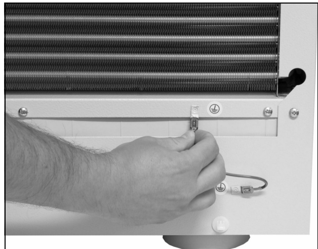
Imagen 27: Desconectar el cable de puesta a tierra
