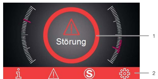
Abb. 44: Bildschirm bei Auftreten einer Störung
