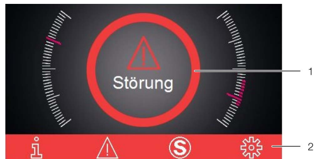
Abb. 25: Bildschirm bei Auftreten einer Störung
