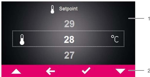
Fig. 22: Screen for changing a parameter value
