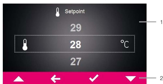
Fig. 22 : écran lors de la modification de la valeur d'un paramètre
