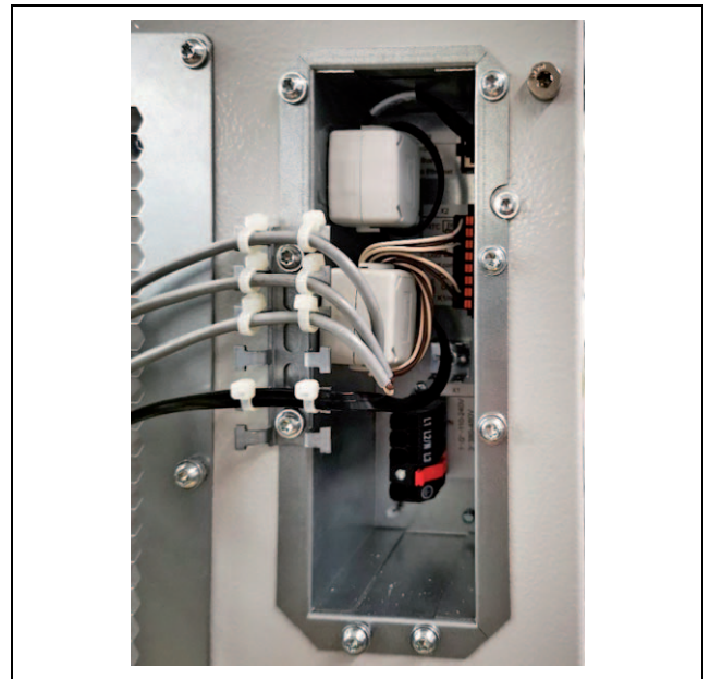
Bild 33: Ferritkärnans montagepunkt för SK 3486330, SK 3487330, SK 3488340 och SK 3489340
