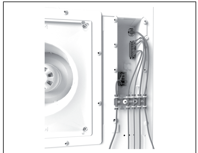
Afb. 40: Realiseren van de trekontlasting met kabelbinders (voorbeeldweergave)
