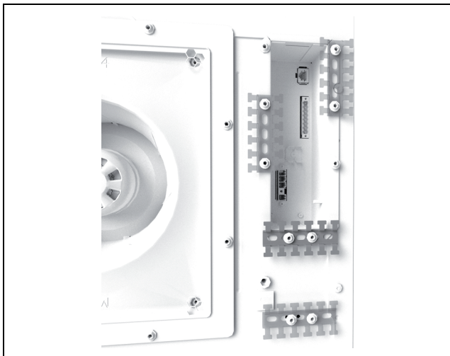
Imagen 39: Montaje de la guía dentada (imagen de ejemplo)
