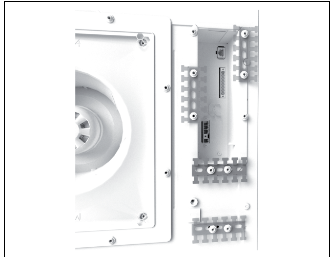
Fig. 39: Applicazione della guida con profilato dentellato (figura a titolo d'esempio)
