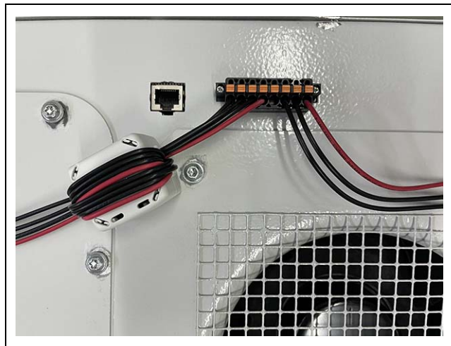
Bild 10: Signalkabel med monterad ferritkärna
