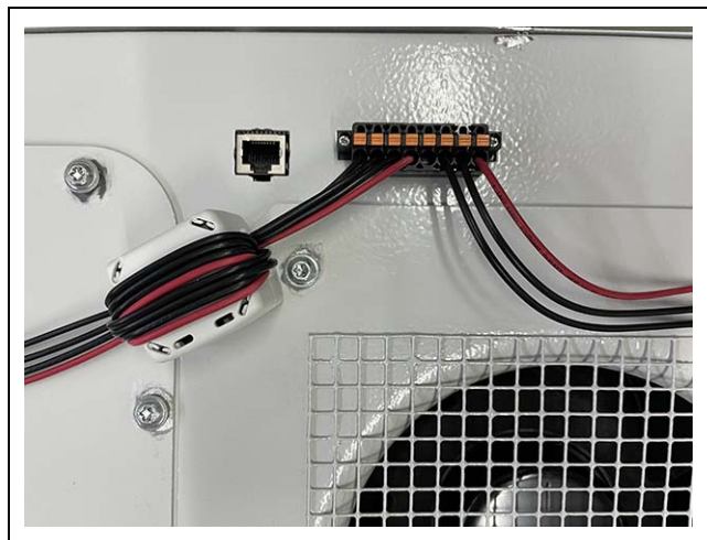
图片 10: 安装有铁氧体磁芯的信号电缆
