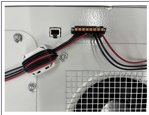
イラスト 10: フェライトコアが取り付けられた信号ケーブル
