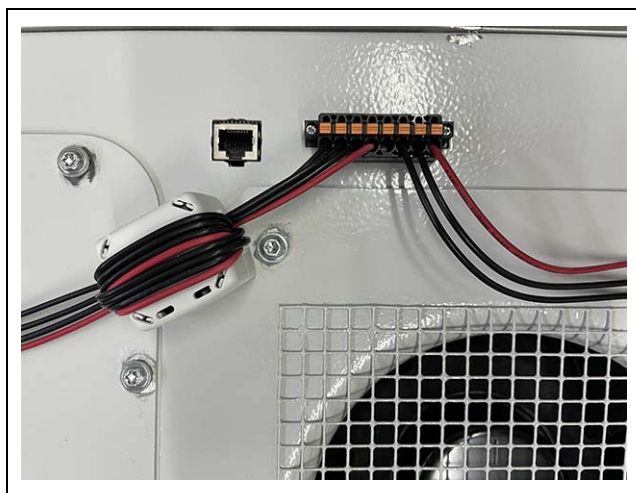
Fig. 10: Cabo de sinal com núcleo de ferrite montado
