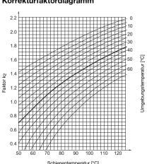
bei I<sub>N</sub> > 2000 A unter Verwendung von Filterlüfter SK 3244.100
