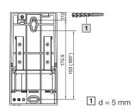
Befestigungsmöglichkeiten auf Tragschiene
