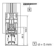
Befestigungsmöglichkeiten auf Tragschiene
