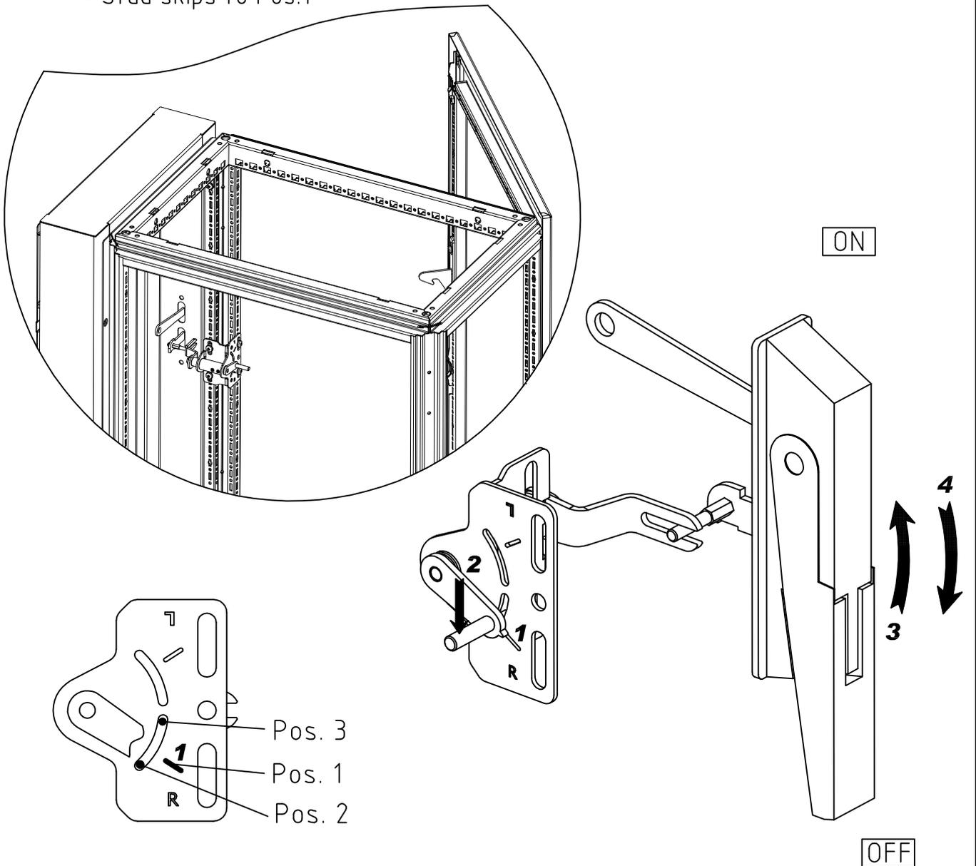
Funktionsprüfung (spannungsfrei) / funktion test (power disconnected)
