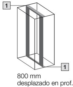
1 Juego de montaje para armarios de 800 mm de ancho
