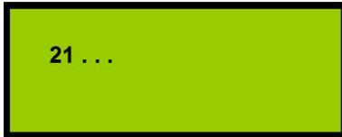
Die aktuellen Werte werden ermittelt! Der angezeigte Wert zählt bis 64 hoch (Fortschrittsanzeige). In dieser Phase ist keine Bedienung möglich.
