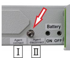
Abb. 49: Blockierschalter (auf der Rückseite des Systems)
