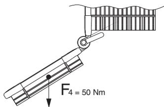
Корпус многосекционный/на шарнирах
