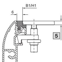
Передняя панель, крепление снаружи на винтах
