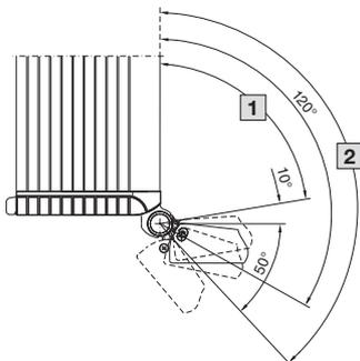
Угол наклона бесступенчато регулируется от 80° до 140°
