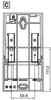
Befestigungsmöglichkeiten auf Tragschiene
