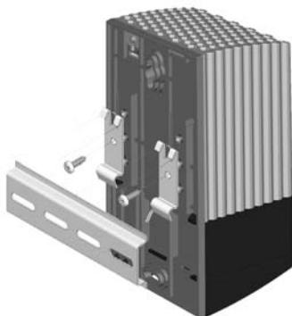
Abb. 1.1: Schnappbefestigung auf 35 mm-Tragschiene DIN EN 50 022
