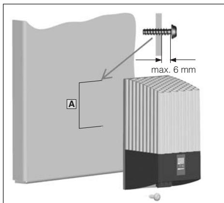
Abb. 1.2: Schraubbefestigung auf Montageplatte
