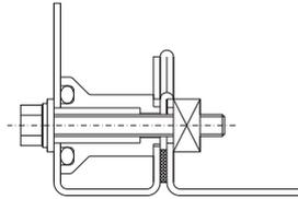
Vis encaissée avec capuchon en plastique
