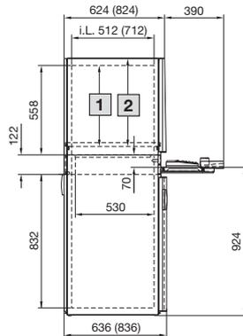
Con vano di installazione ridotto e cassetto
