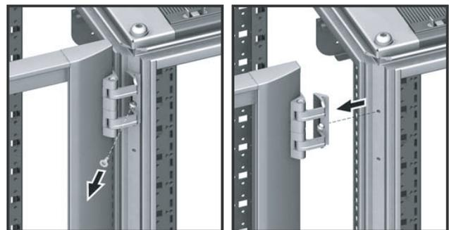
Fig. 13: Removing a door hinge
