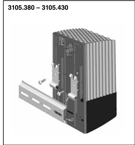
Fig. 2: Fixation par encliquetage sur rail porteur de 35 mm DIN EN 50 022
