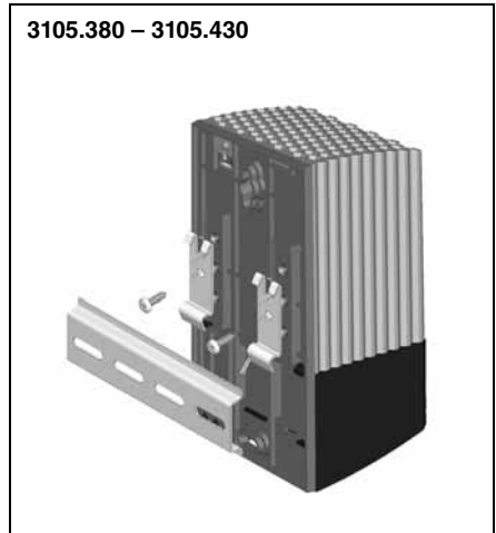
Imagen 2: Fijación a presión sobre carril soporte de 35 mm según DIN EN 50 022
