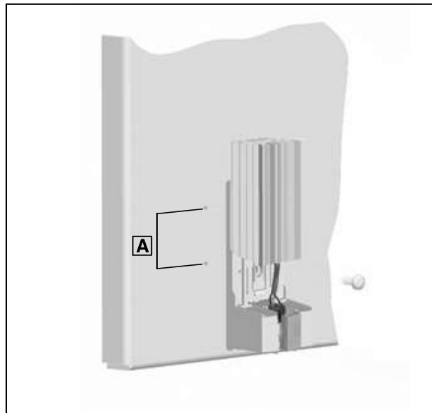
Afb. 3: Schroefbevestiging op montageplaat
