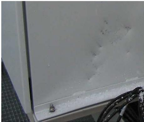
Neben der Schutzart IP ist auch der IK-Code nach IEC 62 262 von Bedeutung. Diese Norm legt die Klassifizierung der Schlagfestigkeit eines Gehäuses fest, also den Grad der mechanischen Beanspruchung bzw. Energieeinwirkung auf das Gehäuse von außen. Dabei gelten für Leergehäuse nach IEC 62 208 die Bedingungen, dass die IP-Schutzart, sowie Isolationsfähigkeit und die Funktionen des Gehäuses und des Innenlebens erhalten bleiben müssen. Gerade in Umgebungen, wo mit der Gefahr von
