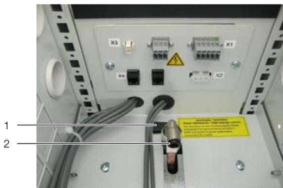
Abb. 53: Entlüftung des Wärmetauschers
