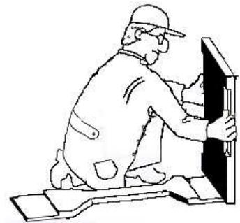
④ Von der Vorderwand, die aus 2 Teilen besteht, zuerst die größere Platte unten und danach die kleinere Platte oben mit je 2 Schrauben und Winkel mit den Seitenteilen verbinden.
